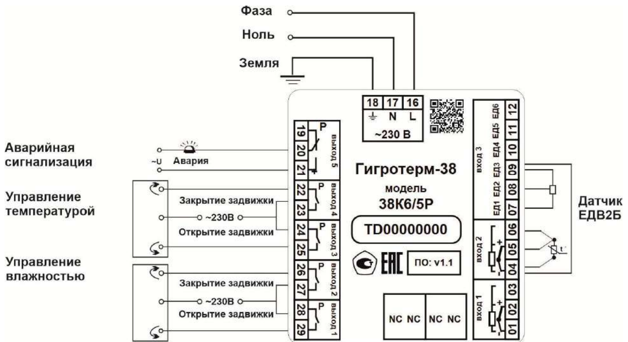
Схема 1. Регулирование влажности и температуры с использованием электрораздвижек. Для измерения влажности и температуры применяется датчик ЕДВ2Б
