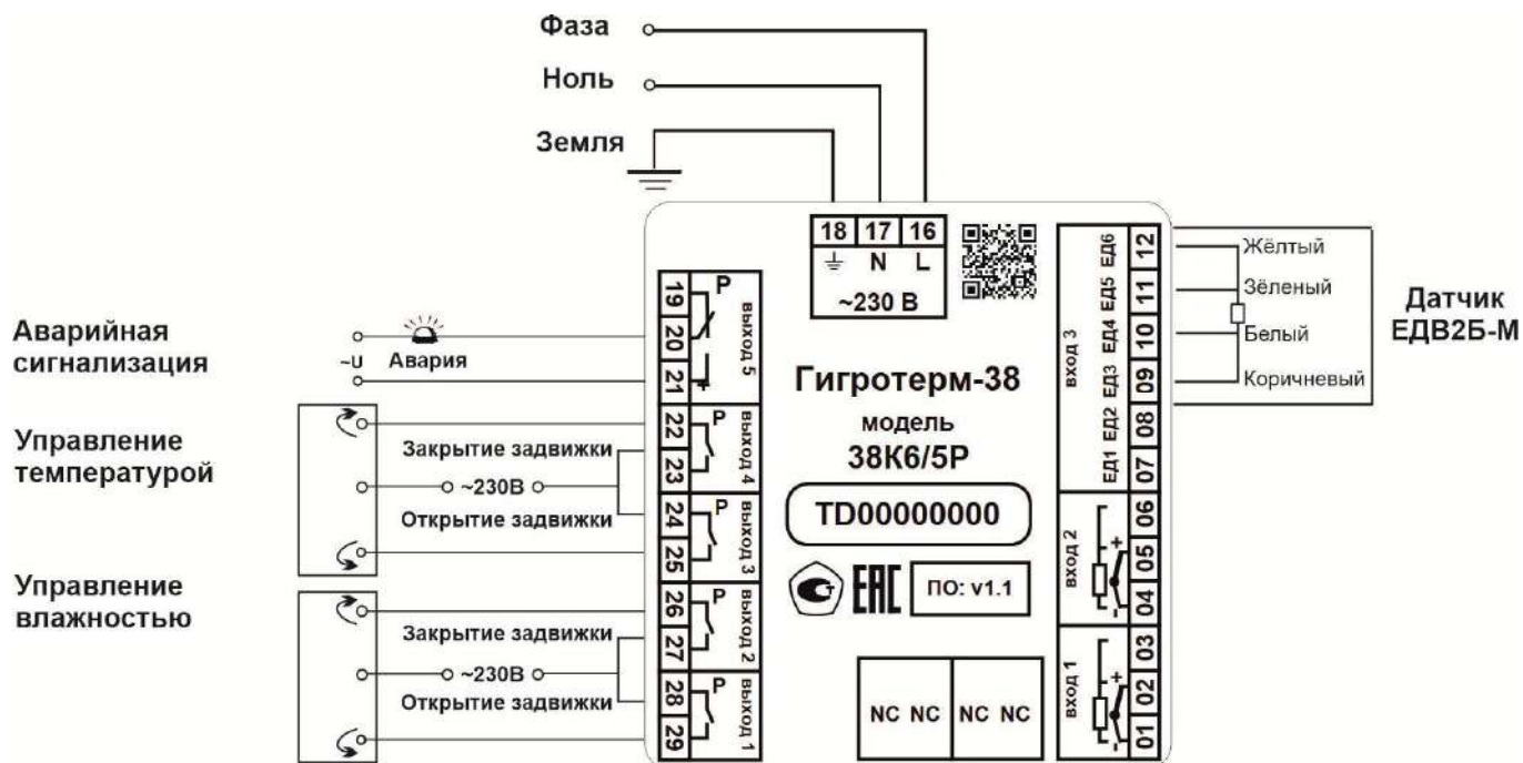
Схема 3. Регулирование влажности и температуры с использованием электрораздвижек. Для измерения влажности и температуры применяется датчик ЕДВ2Б-М
